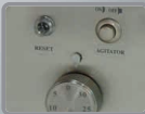
Pannello comandi con timer permette di regolare la durata ideale del ciclo in rapporto al tipo di miscela. Command panel with timer allows the user to set the real length of the batch freezer in relation to the type of mix.
